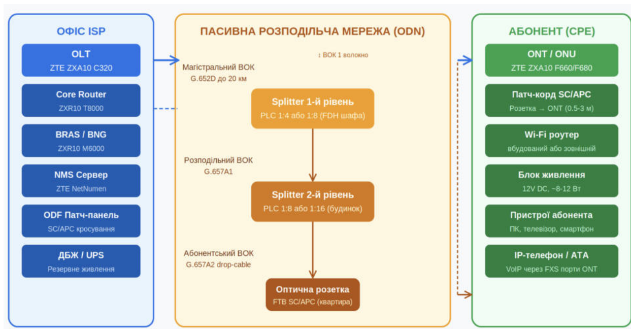
Рисунок 2.5 – Структура GPON-мережі
