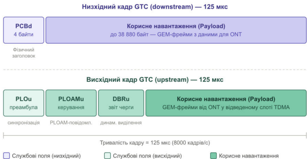
Рисунок 2.4 – Структура кадру GTC мережі GPON
