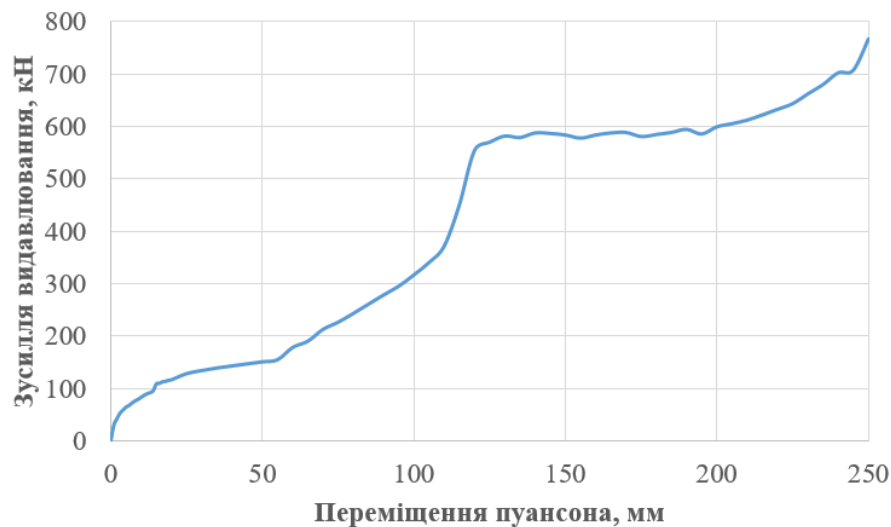
Рис. 3.2. Залежність зусилля видавлювання від переміщення пуансона
