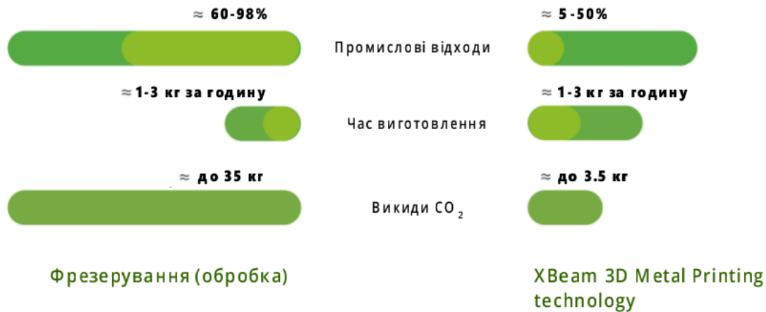
Рисунок 1.2.2. Порівняння виробництва титанових деталей методом фрезерування та 3Д друком.[5]
