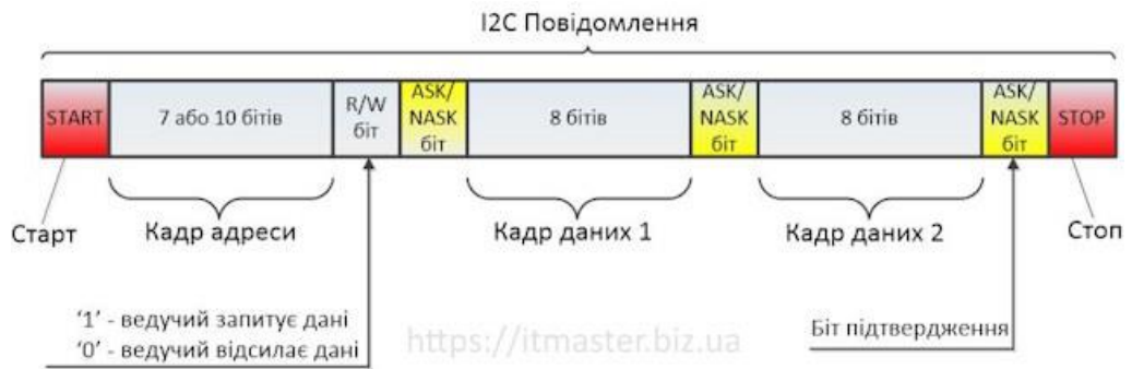
Рисунок 2.3 - Графічне зображення структури повідомлення I2C
