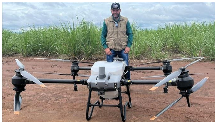
Рисунок. 1.3 – DJI Agras T40 – дрон для обробки полів.
