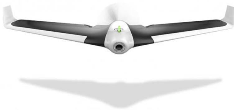
Рисунок. 1.6 – Безпілотник за літаковим типом літального апарату
