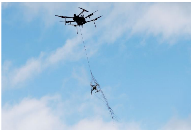
Рисунок. 1.13 – Дрон перехоплювач з сіткою
