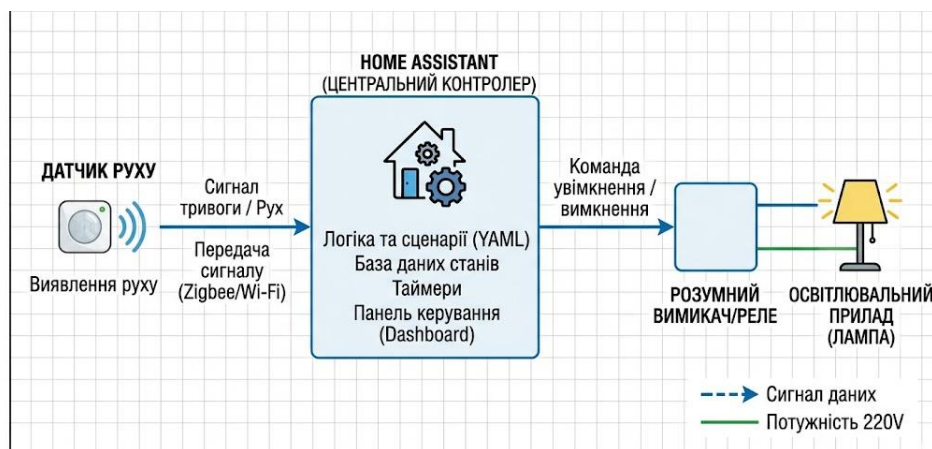
Рисунок 3.4 – Схема автоматичного керування освітленням
