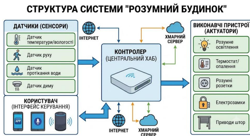
Рисунок 2.1 – Структурасистеми «розумного будинку»
