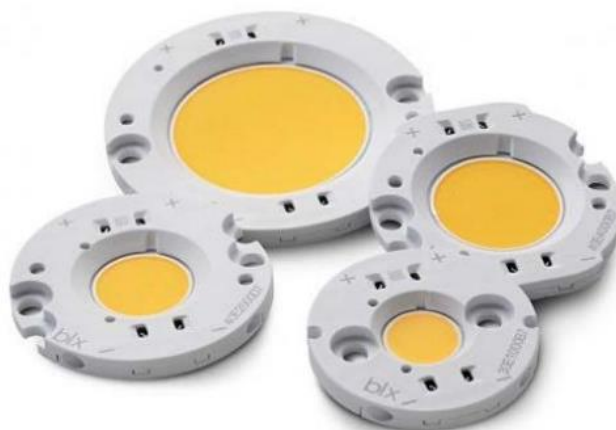
Рис. 3.2. – COB-модулі Bridgelux Vero SE різних розмірів.[24]
