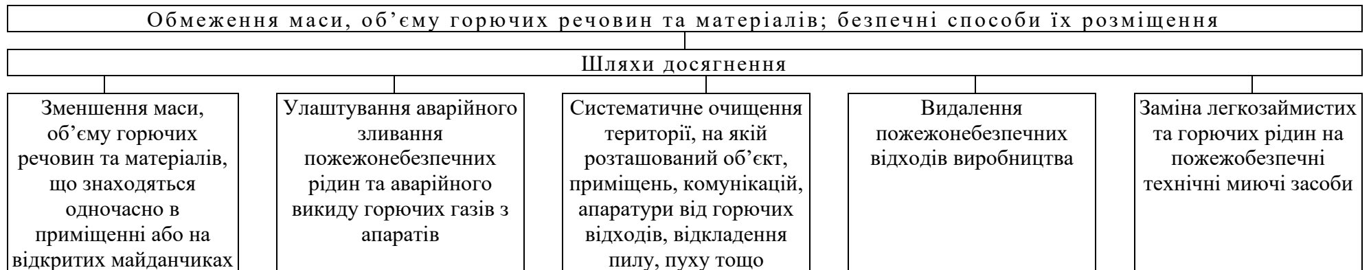
Рисунок 11. 4 . Способи обмеження маси, об'єму горючих речовин та матеріалів
