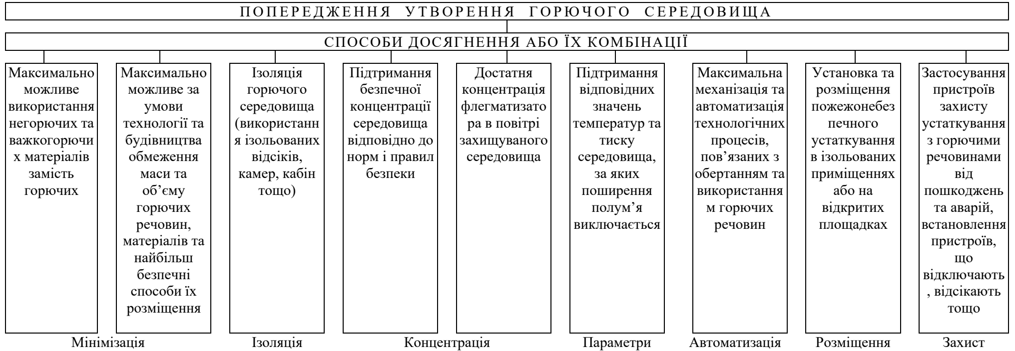
Рисунок 11.3 . Схема забезпечення попередження утворення горючого середовища
