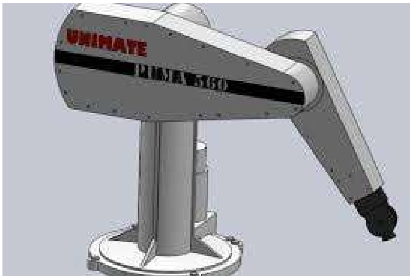
Рис. 1.12. Модель робота PUMA [10]
