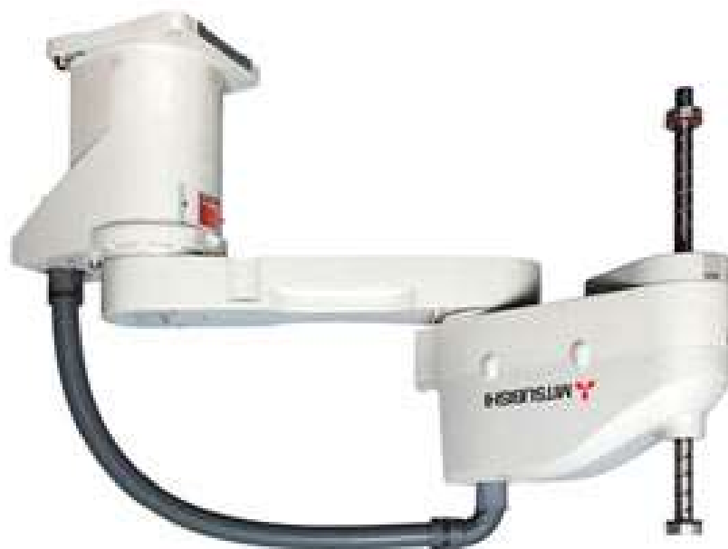
Рис. 1.10. Модель робота SCARA [8]
