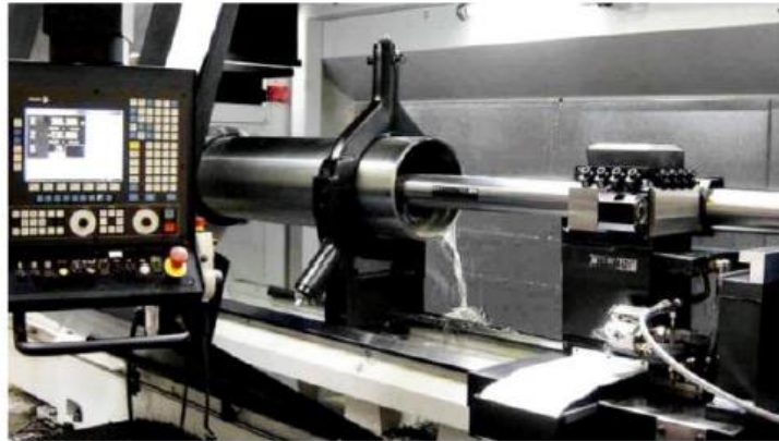
Рисунок 1.23 – Пристрій для глибокого розточування
