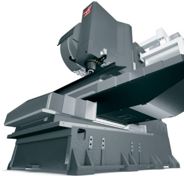
Рисунок 1.2 – Станина обробних центрів Haas
