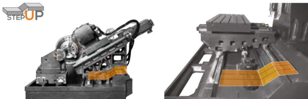
Рисунок 1.7 – Конструкція напрямних стола обробних центрів JYOTI
