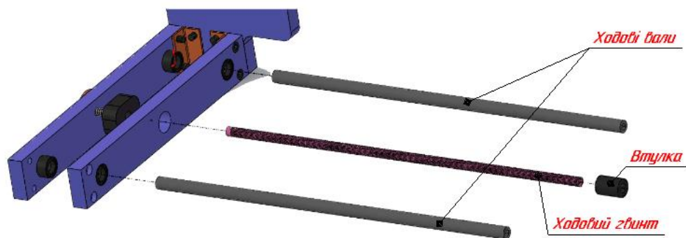
Рисунок 3.29 – Встановлення ходового гвинта, муфти та ходових валів.
