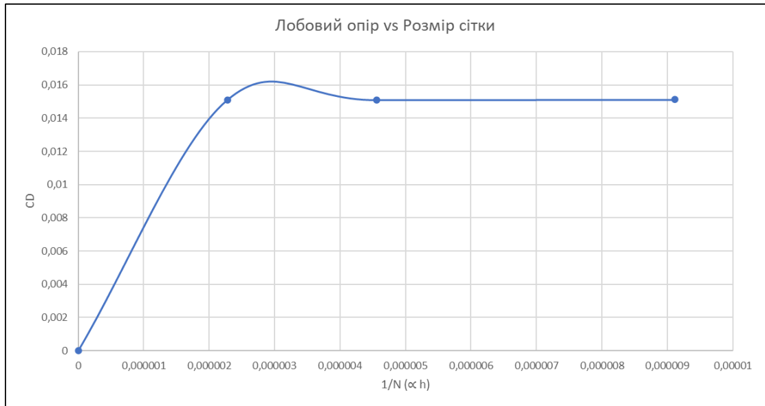
Рис 4.10. Збіжність по лобовому опору коливального характеру
