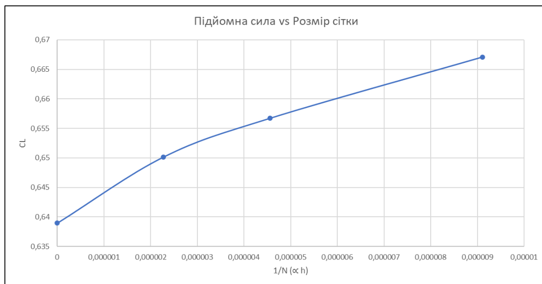
Рис 4.9. Збіжність по підйомній силі монотонного характеру
