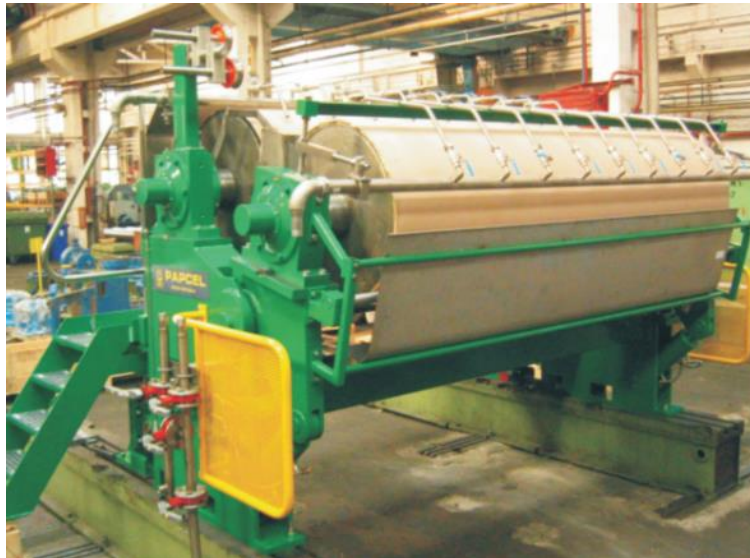
Рисунок. 3.3. – Клеїльний прес Size Press фірми «Parcel»
