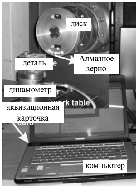
Рис. 3. Установка для измерения сил микрорезания
