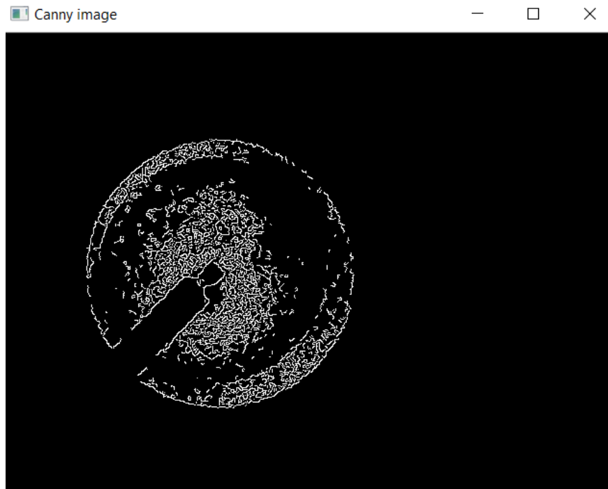
Рисунок 2.10. Знайдені контури за допомогою алгоритму Кенні.
