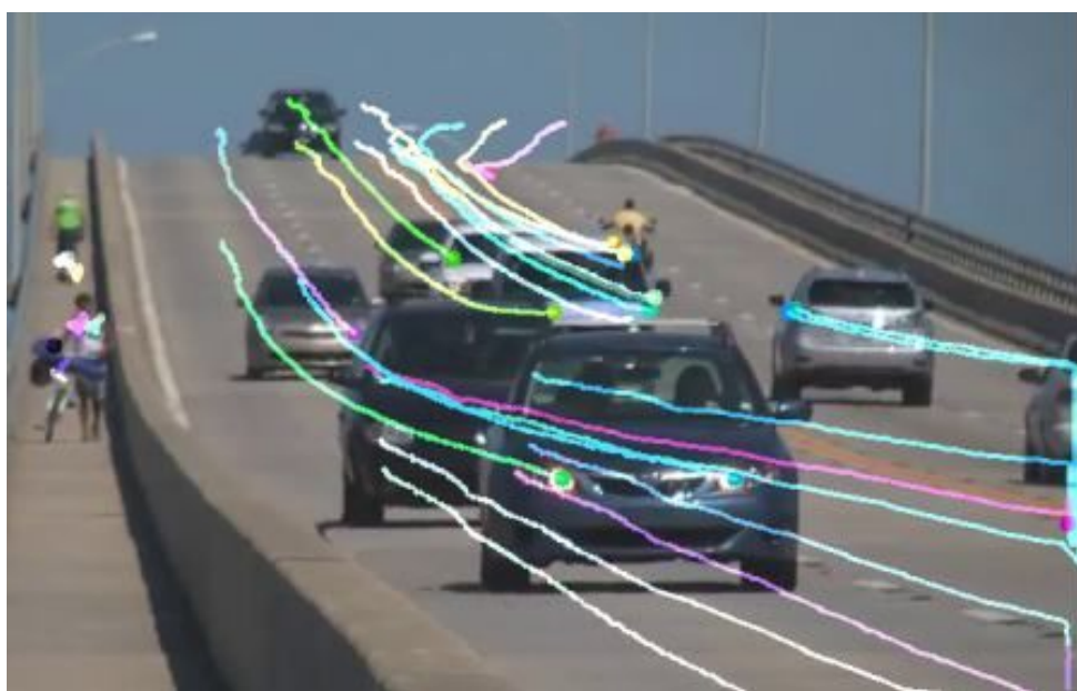
Рисунок 2.2 — Результат роботи методу Lucas-Kanade
