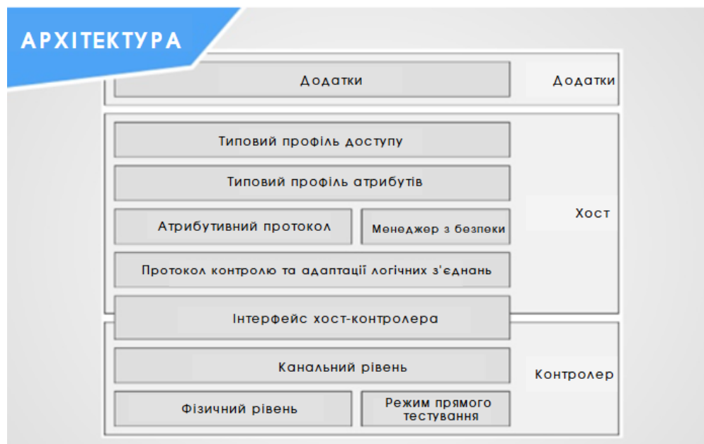
Рисунок 1.4 - Зображення, що демонструє архітектуру протоколу Bluetooth Low Energy (BLE)
