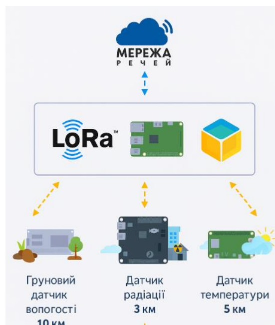
Рисунок 2.2 - Приклад побудови мережі LoRaWAN для моніторингу сенсорів
