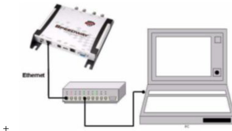
Рисунок 2.3 –Підключення зчитувача Impinj кабелем Ethernet
