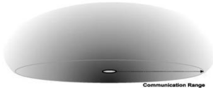
Рисунок 3.3 — Зменшення потужності сигналу з ростом відстані
