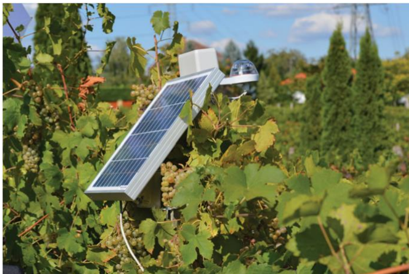
Рисунок 1.11 — Сенсорний вузол від SmartVineyard Solutions, встановлений на органічному винограднику в Словаччині.
