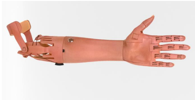
Рисунок 1.9 – Конструкція Truelimb Prosthetic Arm [5]
