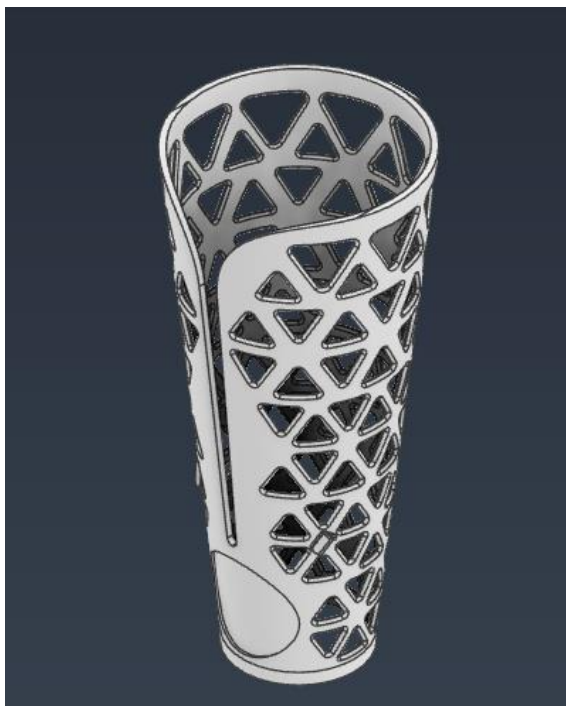
Рисунок 2.7 – Гільза з трикутною формою перфорації
