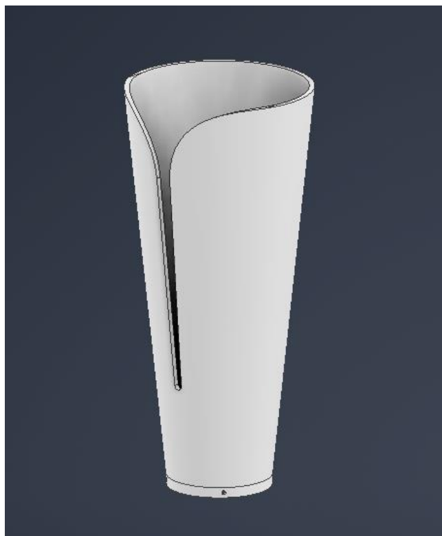
Рисунок 2.5 – 3D-модель приймальної гільзи
