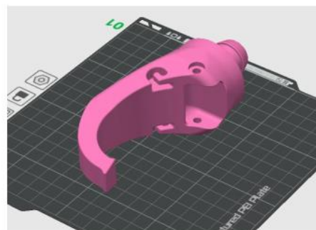
Розташування деталі в робочому просторі для запобігання негативного впливу явища анізотропії на механічні властивості готового виробу
