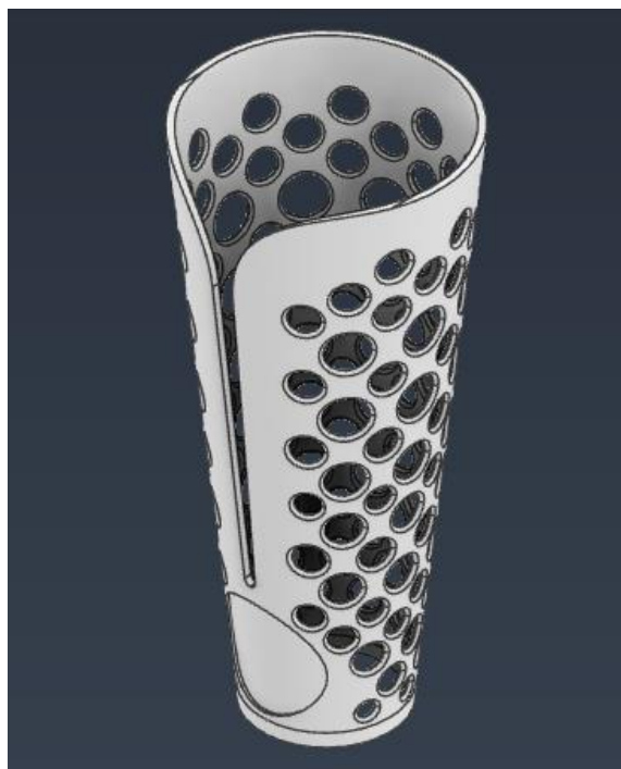
Рисунок 2.8 – Гільза з круглою формою перфорації
