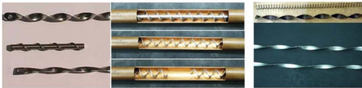
Рис.5.1. Типи закручування потоку в теплообмінних апаратах:
