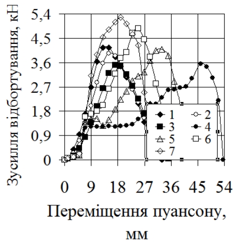
Рисунок 11. Залежність зусилля відбортуння заготовок від переміщення пуансону: а) відбортуння пуансонами різної геометричної форми (1 - r=5\text{мм} , 2 - r=7\text{мм} , 3 - r=10\text{мм} , 4 - \alpha=30^\circ , 5 - \alpha=45^\circ , 6 - \alpha=60^\circ , 7 - r_c=30\text{мм} ); б) відбортуння заготовок з різних матеріалів конусним пуансоном з кутом \alpha=60^\circ
