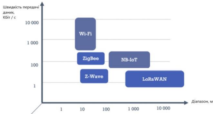
Рис. 2. Графік порівняння протоколів комунікаційних мереж Інтернет речей за дальністю дії та швидкості передачі даних[3]
