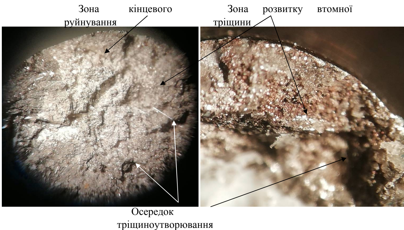
Рисунок 3.6 - Злам зразка зі сплаву ЧС-70, зміцненому іонно-плазмовим азотуванням, після випробування на втомну міцність
