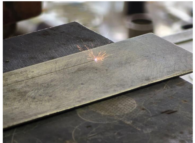
Рис. 4.3.2. Процес лазерного формування зміцнювального мікрорельєфу на поверхні металевих планок
