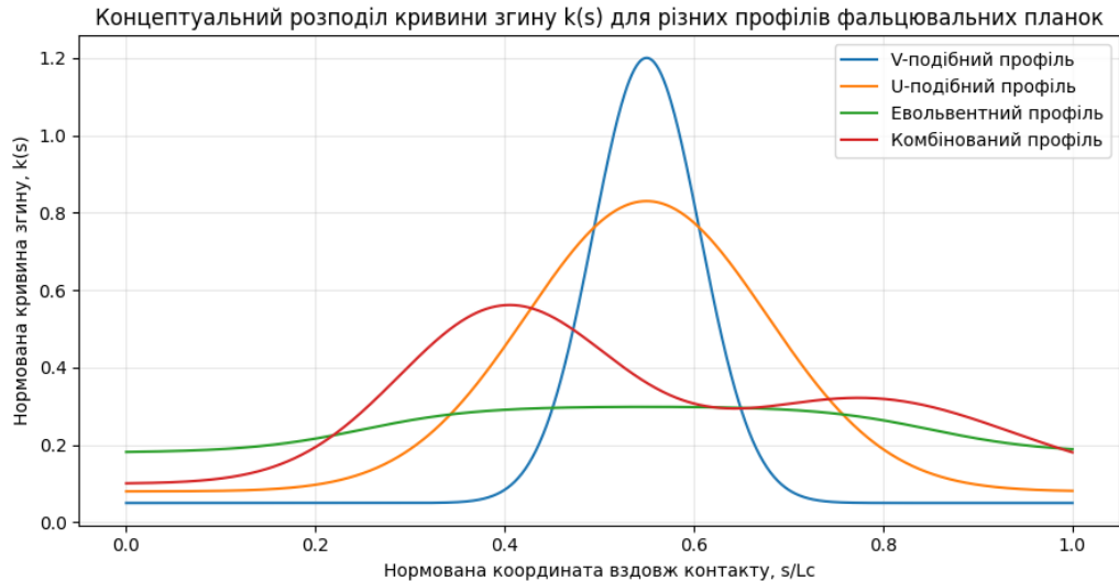
Рис. 2.1.3. Концептуальний розподіл кривини згину k(s) уздовж контактної довжини для різних профілів фальцювальних планок: V-подібного, U-подібного, евольвентного та комбінованого; s – координата вздовж лінії контакту «фальцювальна планка – клапан», k(s)=d\theta/ds – локальна кривина згину [42]
