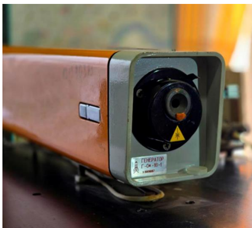
Рисунок 4.2.1. Лазерний генератор та експериментальна установка для формування зміцнювального мікрорельєфу на робочих поверхнях деталей фальцапарату
