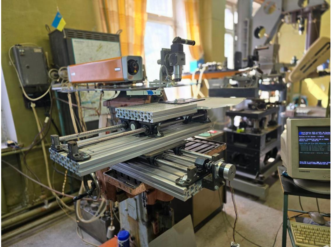
Рис. 4.3.1. Експериментальна установка для технологічного процесу лазерного формування зміцнювального мікрорельєфу на поверхні металевих планок
