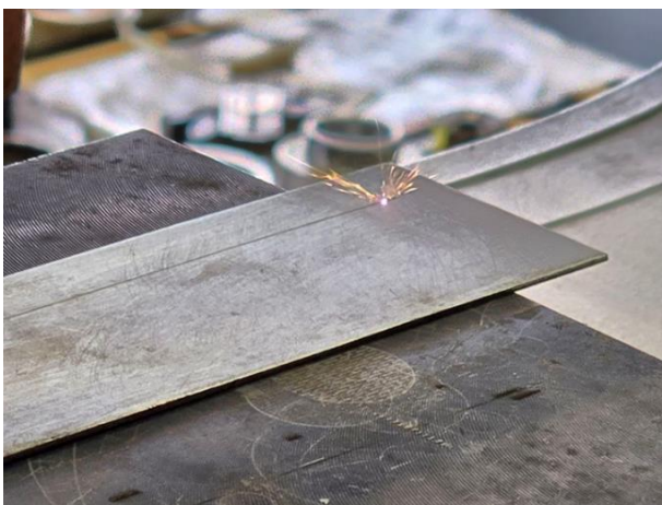
Рис. 4.3.2. Процес лазерного формування зміцнювального мікрорельєфу на поверхні металевих планок
