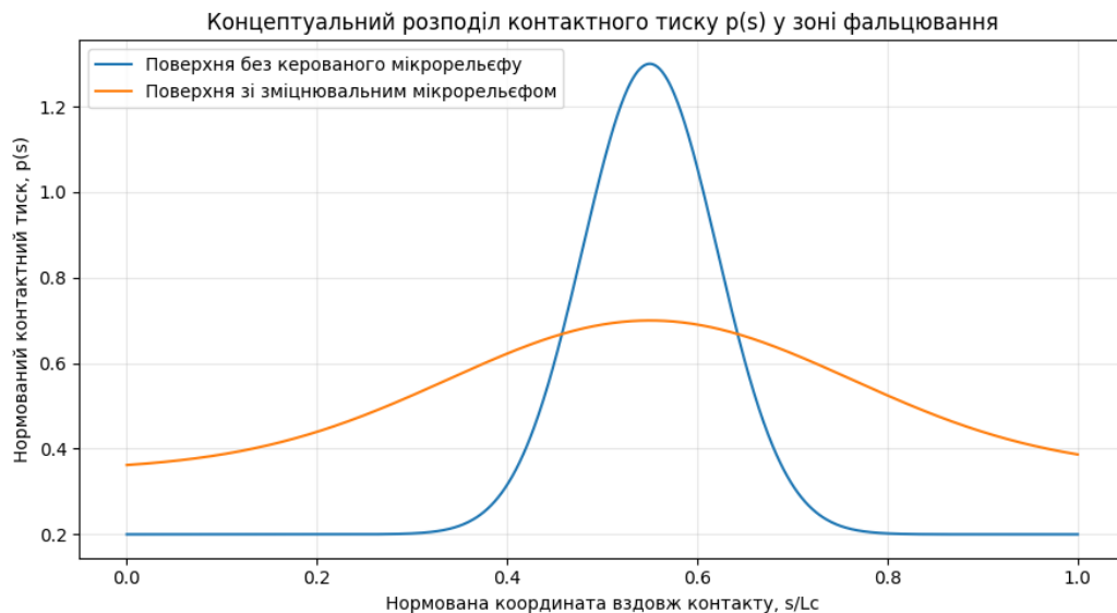
Рис. 2.1.4. Концептуальний розподіл контактної тиску p(s) уздовж контактної довжини у зоні фальцювання: s – координата вздовж лінії контакту, p(s) – локальний контактний тиск [42].
