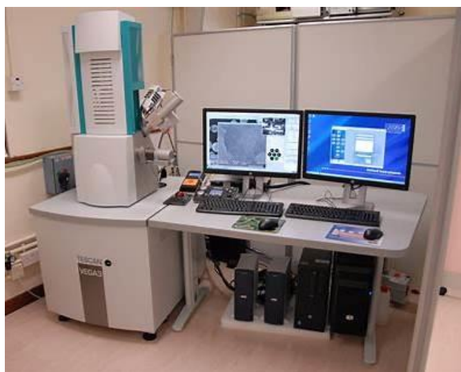
Рисунок 4.2.4. Лабораторне обладнання для мікроструктурних та морфологічних досліджень поверхні матеріалів: оптичний (металографічний) мікроскоп Olympus GX51 і сканувальний електронний мікроскоп TESCAN VEGA 3
