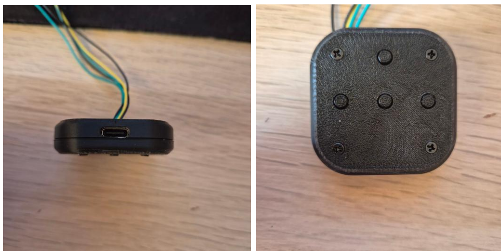
Рис. 3.1 – Керуючий модуль комплексу в корпусі надрукованому на FDM принтері
