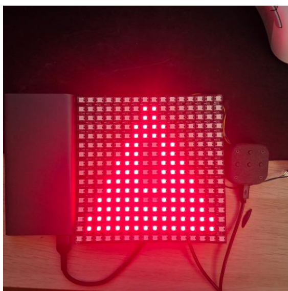
Рис. 4.1 – Випробувальний стенд з живленням від павербанку – в режимі аварійної індикації
