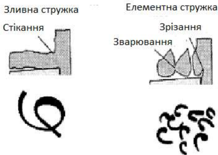
Рис. 2.4 Види стружки
