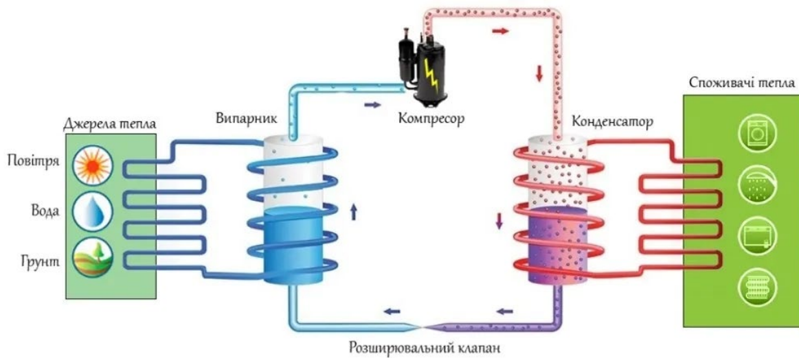
Рисунок 1.2 – Принцип роботи теплового насоса
