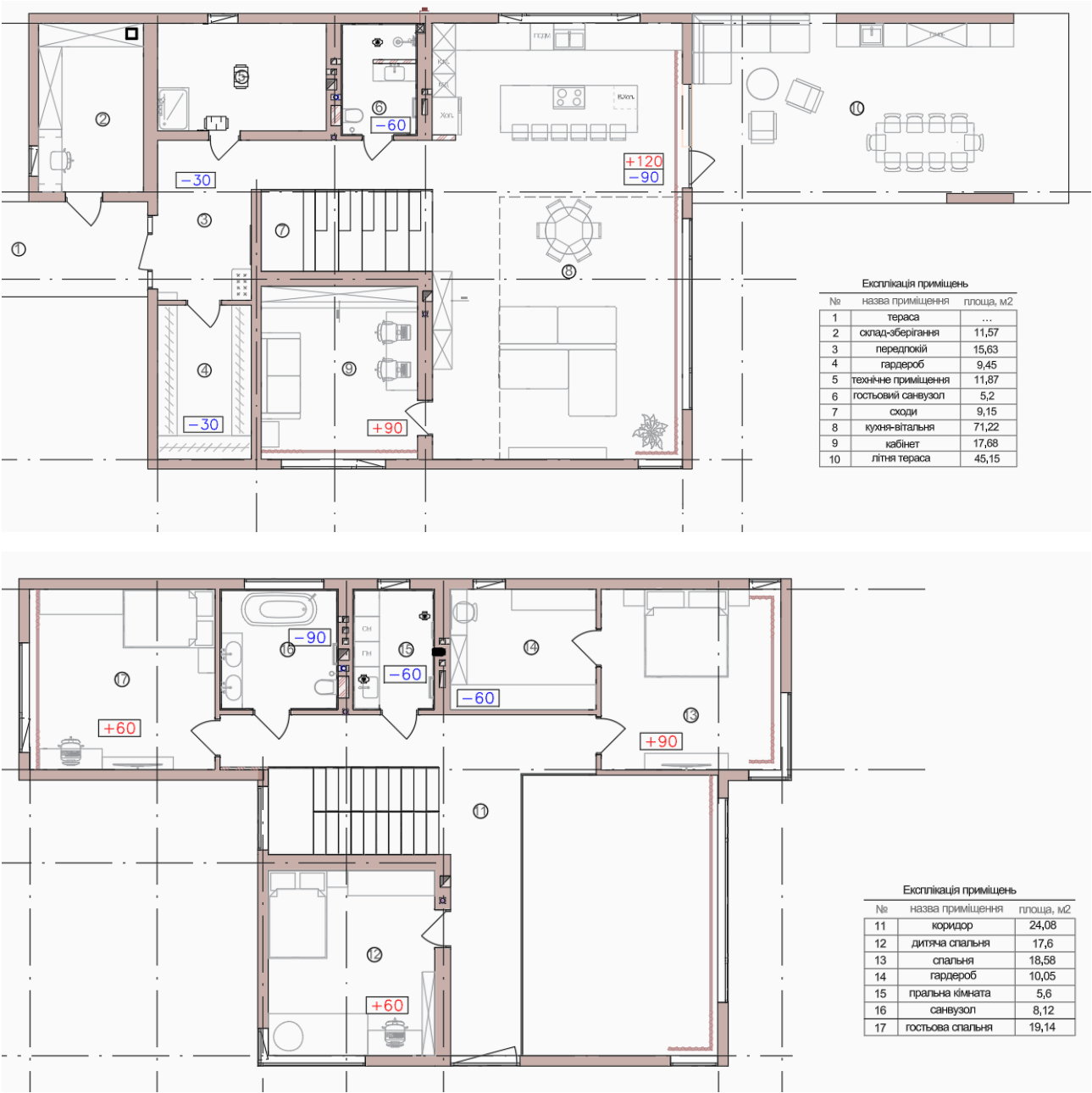
Рисунок 3.4 – Плани з розподілом припливного і витяжного повітря для системи механічної вентиляції по приміщеннях 1-го і 2-го поверхів відповідно
