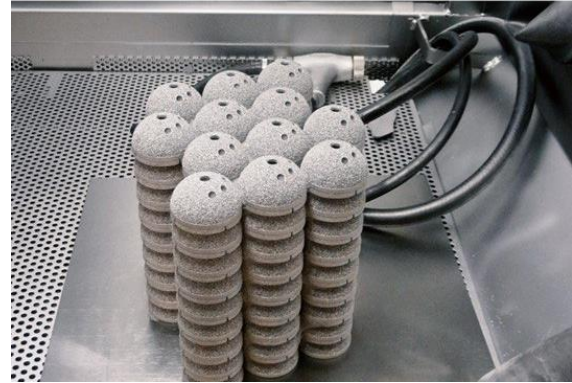
Рисунок 1.2.5 – 3д модель (а) та зовнішній вигляд деталей (б) після ЕВМ [22]
