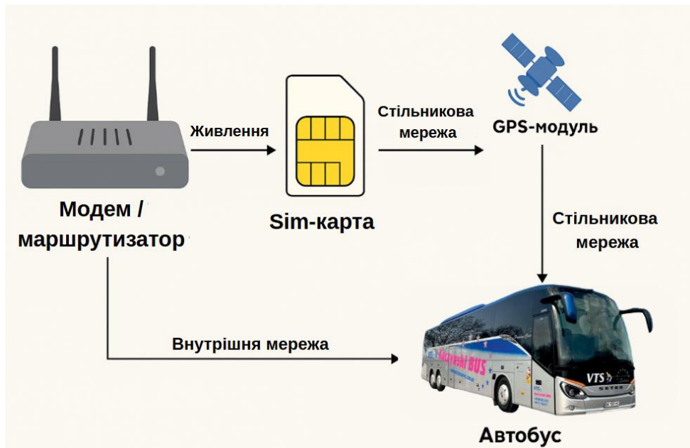
Рис.2.3 Схема підключення модему у автобусі
