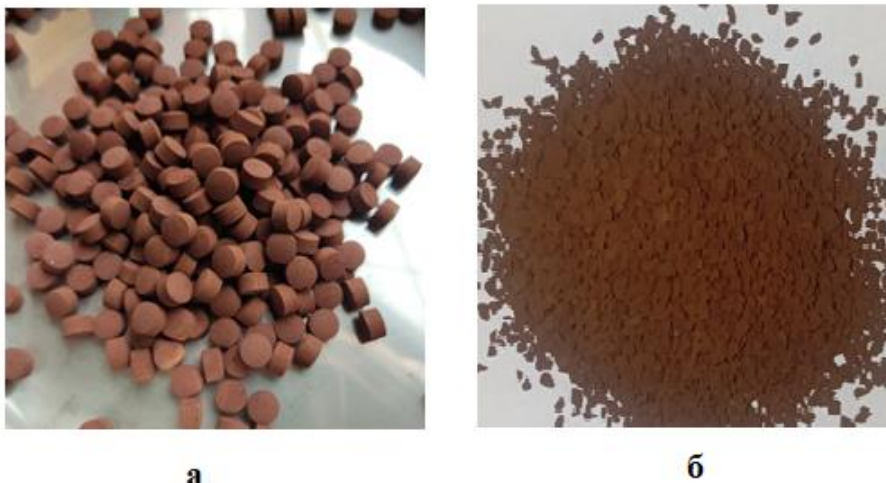
Рис. 2.3. Залізовмісний каталізатор: а – пресований; б – після подрібнення
