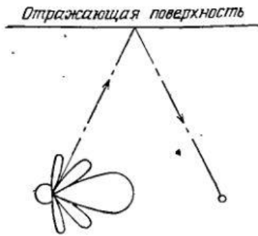
Рис. 2.13 Виключення завади від поверхневого відбиття шляхом орієнтації нуля діаграми направленості гідрофона в напрямленні приходу відбиття
