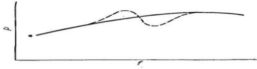
Рис. 2.6 Типовий ефект газової бульбашки в воді поблизу гідрофона
