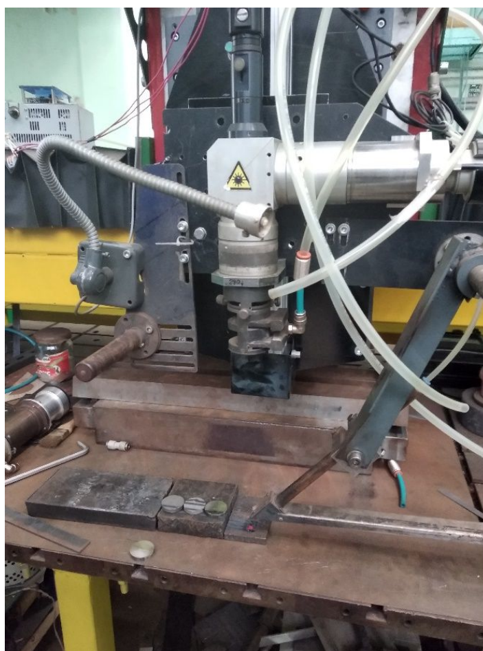
Рис. 1.7.3- Система фокусування лазерного устаткування моделі DY 044.
