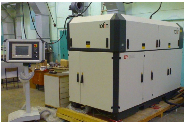
Рис.1.7.1 - Твердотільний технологічний Nd:YAG - лазер зі світлодіодним накачуванням моделі DY 044 з потужністю випромінювання до 4,4 кВт і довжиною хвилі \lambda=1,06 мкм.
