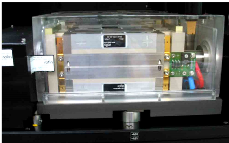
Рис. 1.7.2 - Камера „накачування” лазерної установки ROFIN DY 044.
