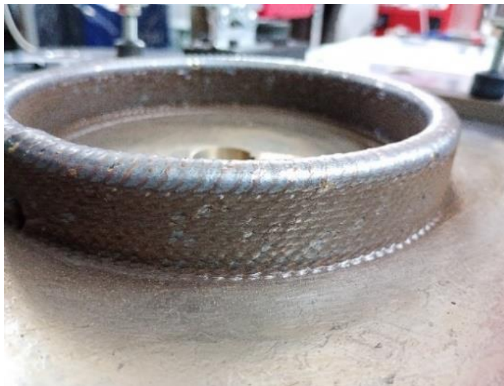
Рисунок 1.7 – Циліндр наплавлений WAAM процесом СМТ технологією
