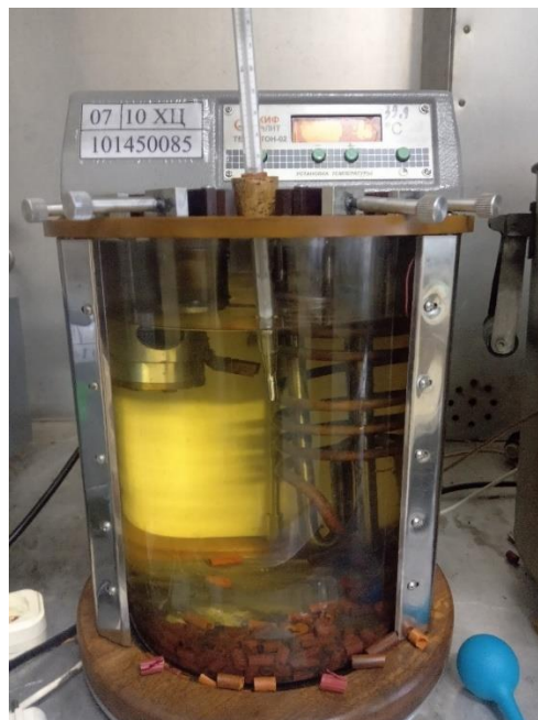
Рисунок 2.1 – Установка термотон – 02 для визначення кінематичної в'язкості.
