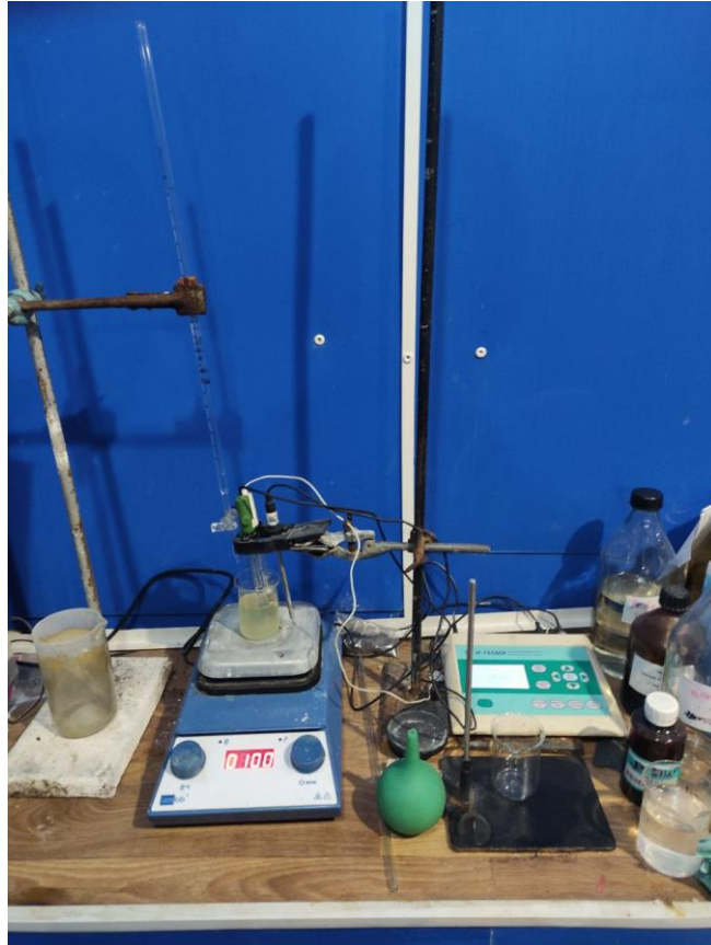
Рисунок 2.3 – Прилад для визначення загального лужного числа потенціометричним титруванням
