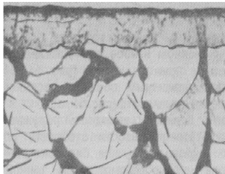
Рисунок 1.9 – Мікроструктура нітрокарбонизованої сталі 20 при 570 °C протягом 2 годин.
