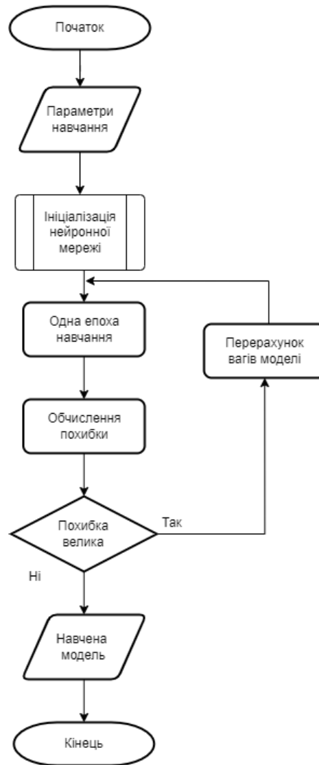
Рисунок 4.3 – Схема алгоритму навчання LSTM
