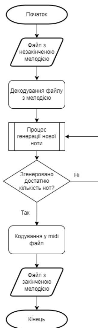
Рисунок 4.4 – Схема алгоритму генерування продовження мелодії
