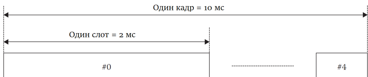
Рис.1.21 Структура кадру висхідної лінії для рознесення між підносійними \Delta f = 3,75 кГц
