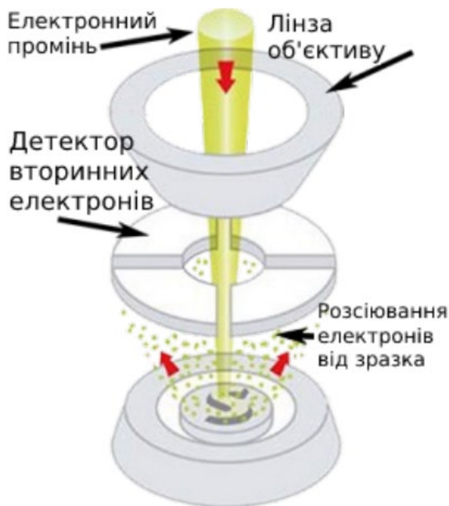
Рисунок 2.6 - Схема детектора зворотно-розсіяних електронів для скануючої електронної мікроскопії [12]
