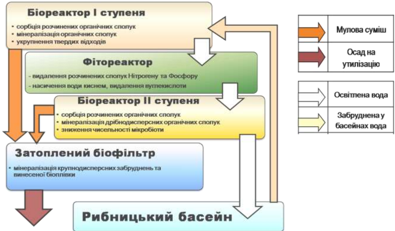
Рис. 8. Принципова схема багаторічної технології біологічного очищення оборотної води
