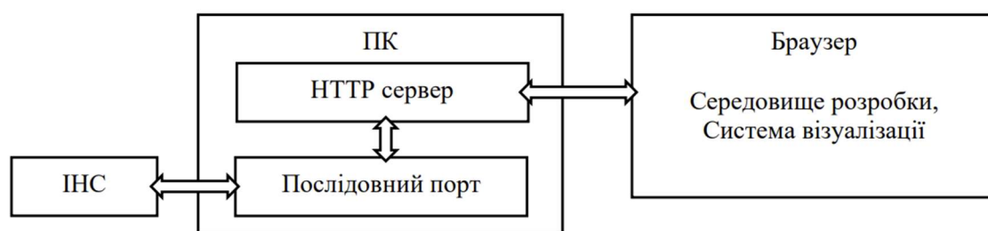
Рис. 2.3. Узагальнена функціональна схема системи візуалізації даних INS-B
