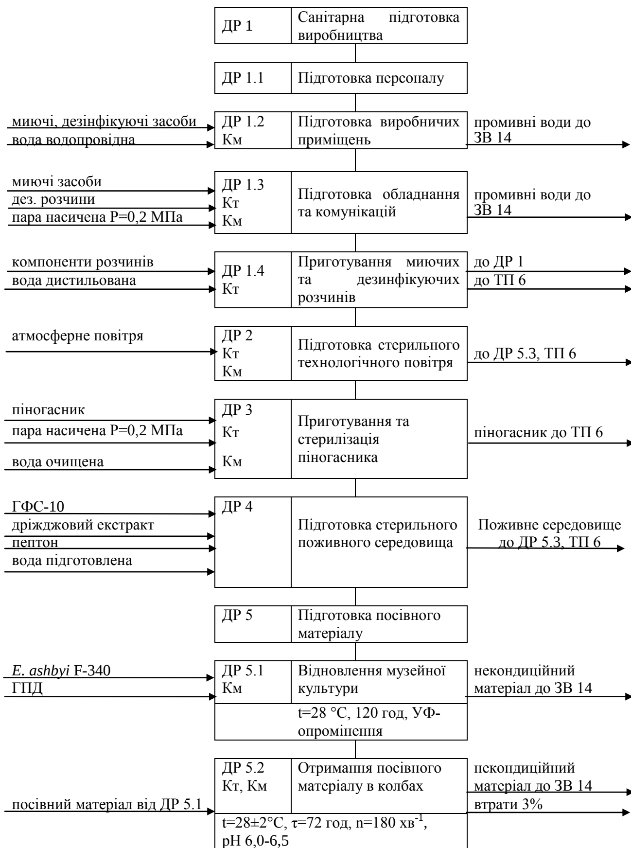
Рис. 7.1 Технологічна схема отримання рибофлавіну та ефірної олії з використанням E. ashbyi F-340
