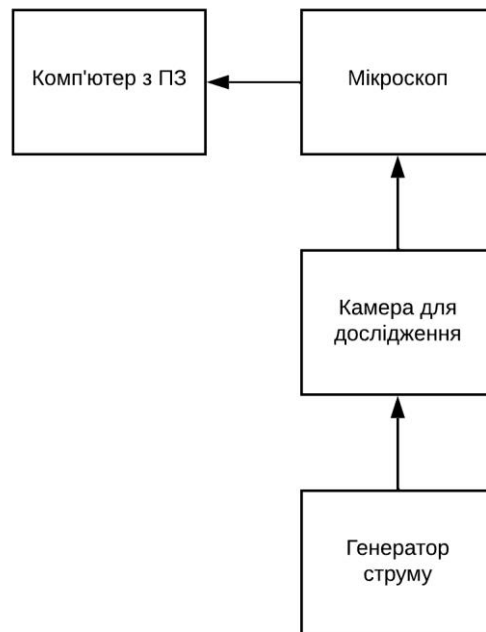
Рисунок 2.1 – Блок-схема прототипу програмно-апаратного комплексу для вимірювання електрокінетичних характеристик клітин
