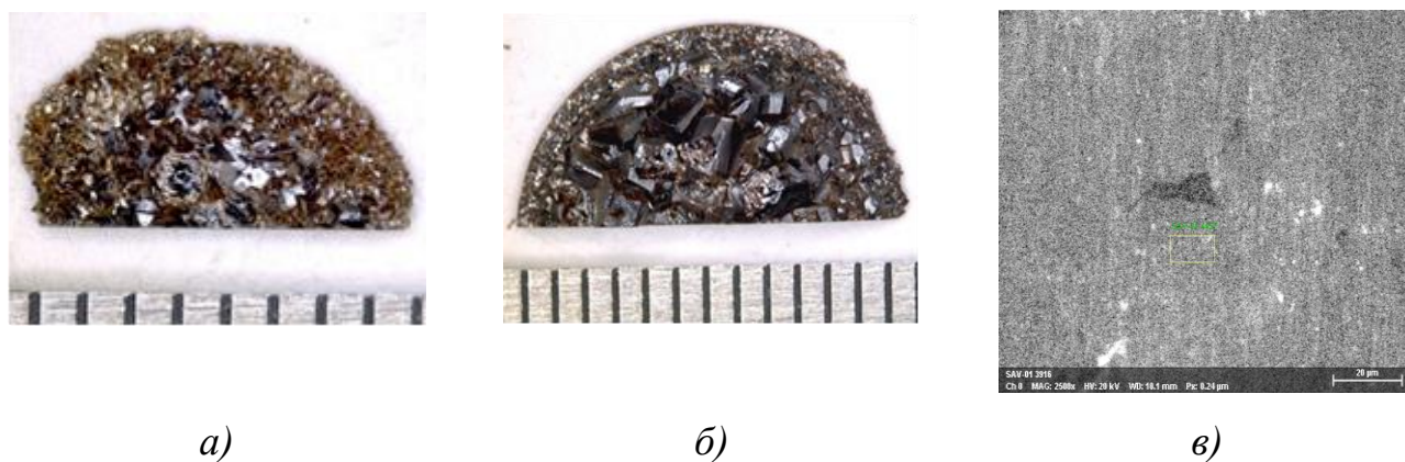
Рисунок 3.7 – Загальний вигляд затравочної частини зразків, отриманих під час другого ( P=4,5 ГПа, T=1400 °C, t=14 год.) (а) та третього ( P=4,5 ГПа, T=1600 °C, t=17 год.) (б) експериментів з вирощування GaN (а). Структура литого сплаву, який використовувався в експериментах з вирощування монокристалів GaN, після виконання експериментів (в)
