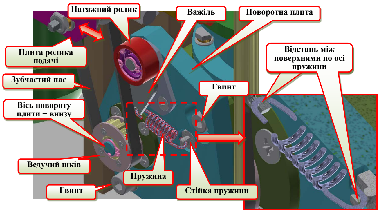
Рис. 12.7. Механізм натягу пасу зубчасто-пасової передачі механізму подачі прутка
