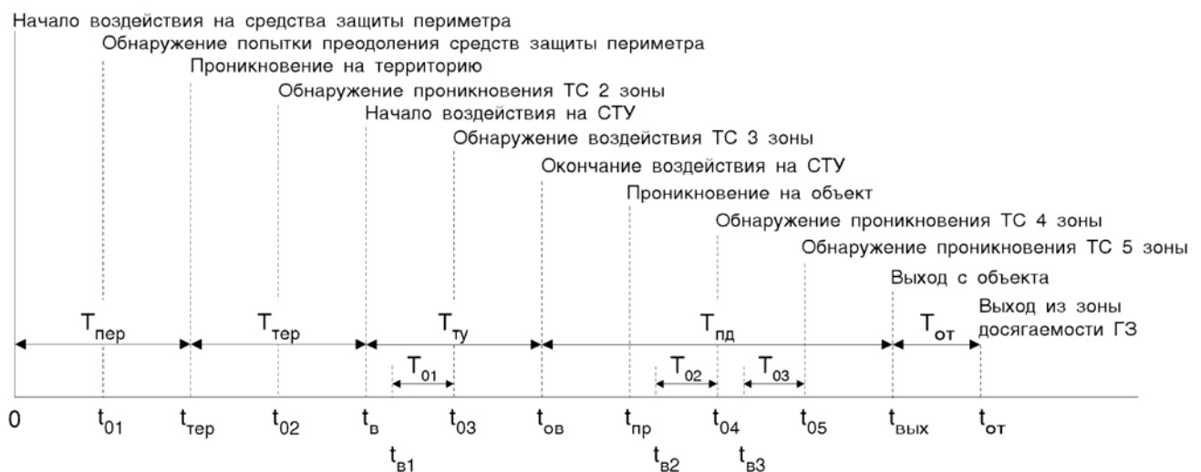
Рисунок 3 – Последовательность событий при проникновении на объект
