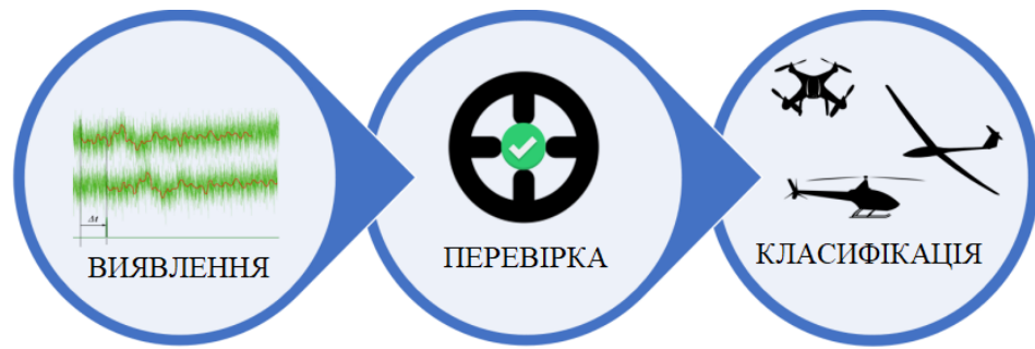
Рисунок 1.1 Послідовність обробки інформації в РЛС
