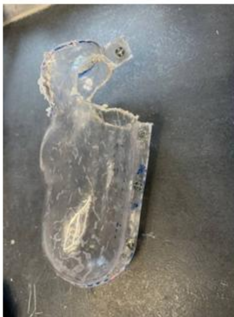
Рисунок 2.16 – Фіксація шва тимчасової гільзи болтами перед шліфуванням
