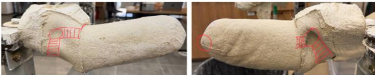
Рисунок 2.8 – Виявлені дефекти позитивної гіпсової моделі перед моделюванням
