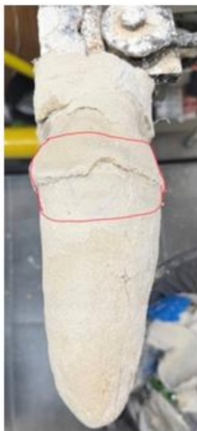
Рисунок 2.9 – Виявлені дефекти позитивної гіпсової моделі перед моделюванням
