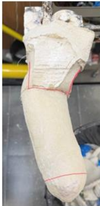
Рисунок 2.7 – Виявлені дефекти позитивної гіпсової моделі перед моделюванням
