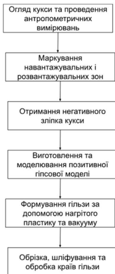
Рисунок 2.1 – Етапи виготовлення тимчасової трансрадіальної гільзи протеза верхньої кінцівки
