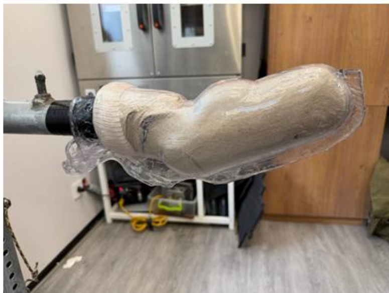
Рисунок 2.14 – Вакуумне формування термопластичного матеріалу на позитивній моделі
