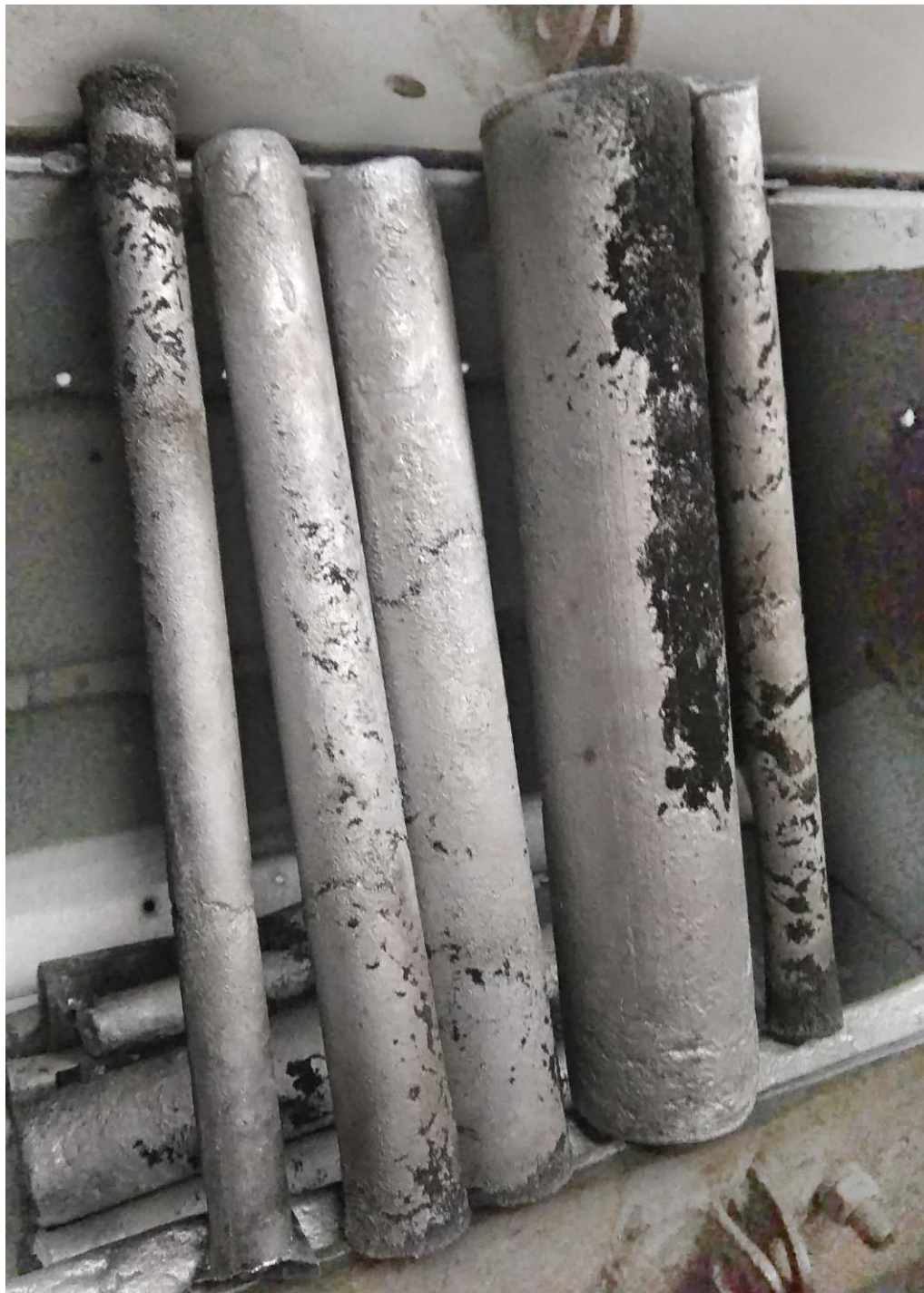
Рисунок 3.7 – Зовнішній вигляд литих пруткових заготовок з алюмінієвого сплаву 1933
