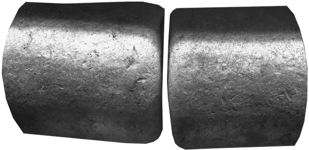
Рисунок 3.8 – Зовнішня поверхня литої пруткової заготовки діаметром \varnothing 75 мм після очищення в галтовочних барабанах і дробеструйної обробки
