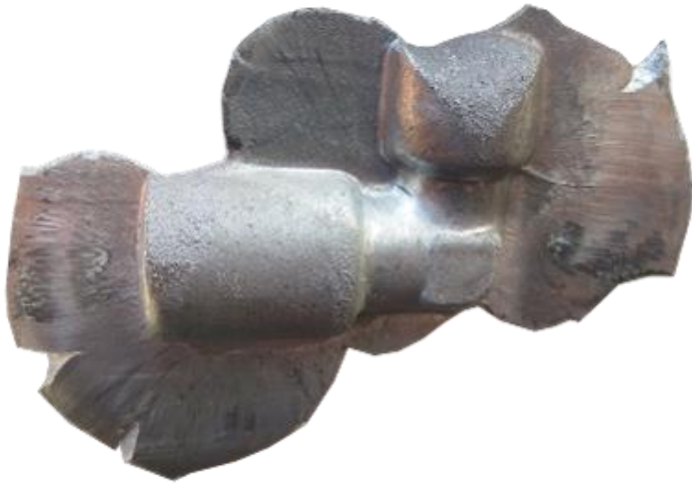
Рисунок 3.15 – Зовнішній вигляд поверхні штамповки з литої пруткової заготовки ливарного сплаву Ак7ч (АЛ9) без травлення та обрізки облоя
