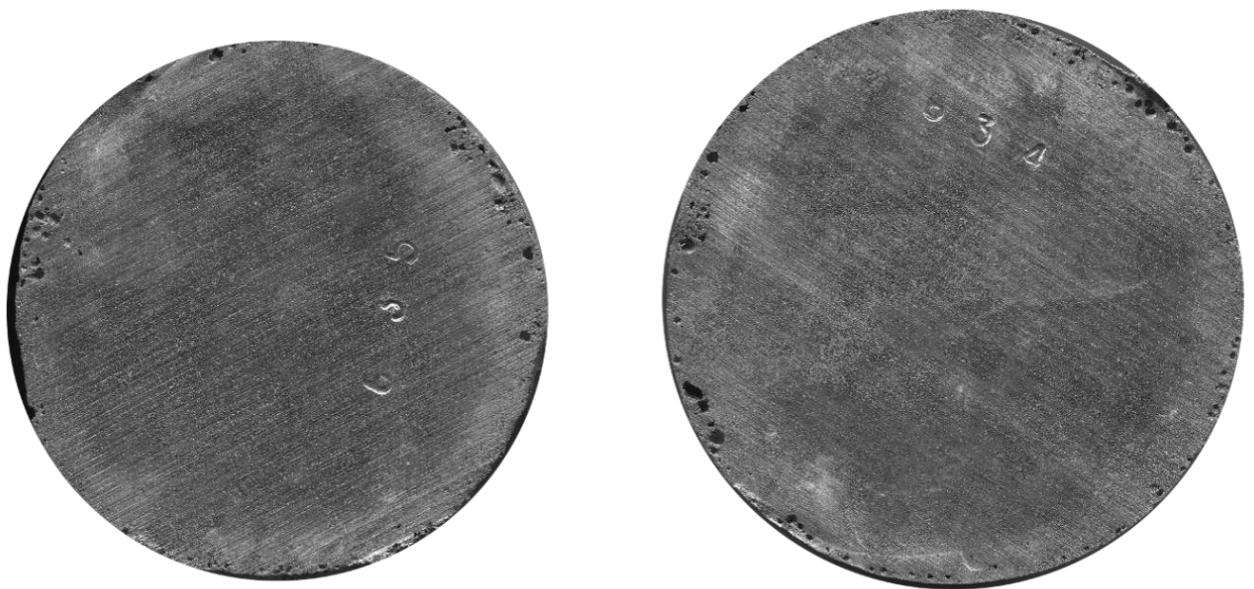
Рисунок 3.9 – Поперечні нетравлені макрошліфи, вирізані із зон, прилеглих до донної та надливкової частин литої пруткової заготовки діаметром \varnothing 75 мм
