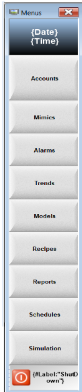
Рисунок 5.12 - Вікно в HMI/SCADA-системі WebStudio. HMI-Standard функціональність : «Menus»
