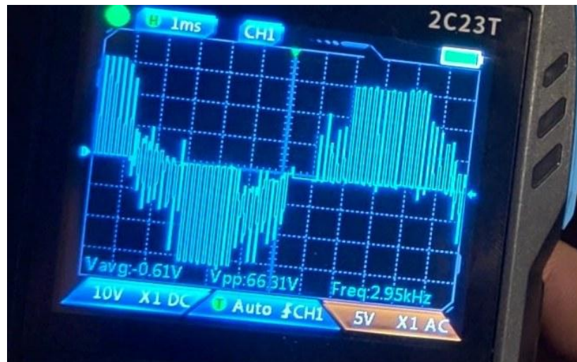
Рисунок 4.6 - Осцилограма фазної напруги обмотки двигуна (SPWM-модуляція)
