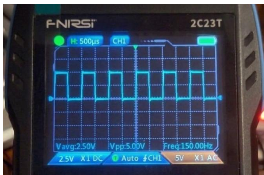
Рисунок 4.7 - Осцилограма сигналу FG зі стандартного виходу ESC в усталеному режимі
