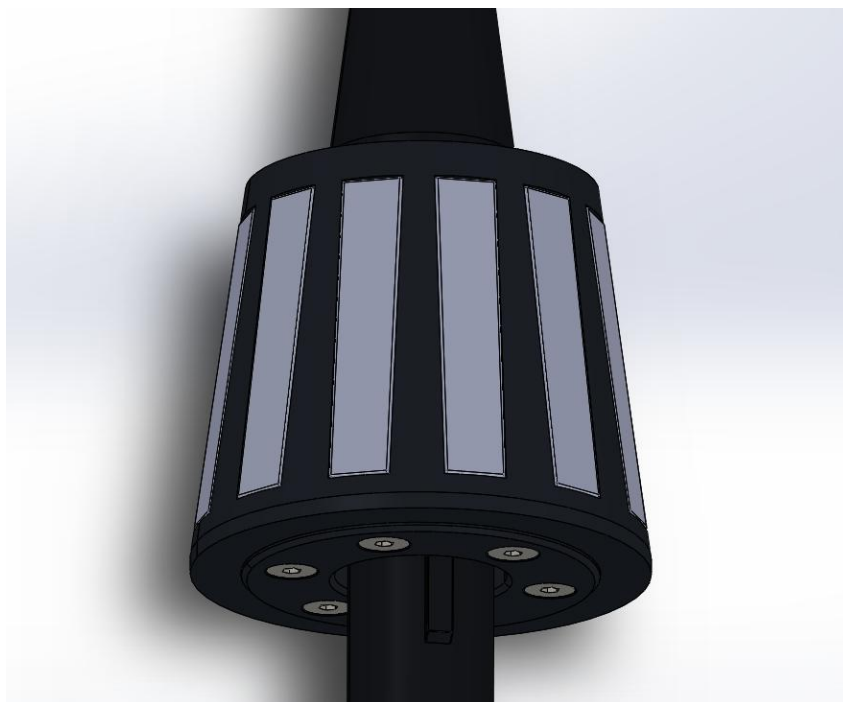
Рисунок 2.1 - Розташування 12 магнітів на конічній поверхні ротора (SPM-конструкція)
