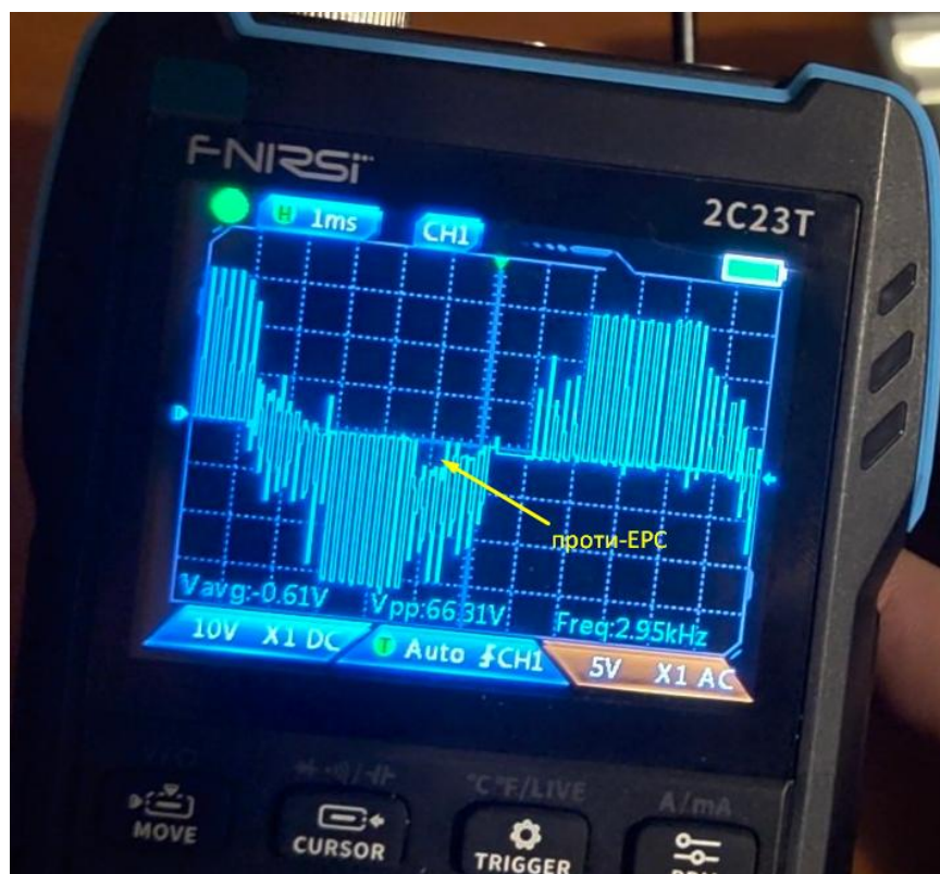
Рисунок 3.5 - Часові діаграми фазних напруг при SPWM-комутації та принцип визначення положення ротора
